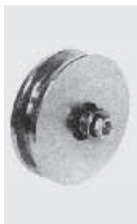
Laufrolle unten, einfach gelagert, galvanisch verzinkt und chromatiert
