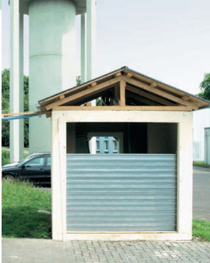
Hochwasserversuch mit dem WP WASTO System bei der FWU, Forschungsstelle Wasserwirtschaft und Umwelt der Universität Siegen: Praktischer Versuch, Abdichtbreite 2000 mm, Stauhöhe 1700 mm
